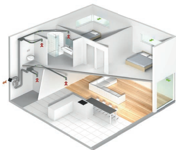
Ventilation mécanique (système C)
