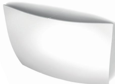
Le modèle est spécialement adapté à la fonction (amenée ou extraction). Il se positionne aisément sur la bouche de réglage. En pratique, la bouche se prête à un montage mural. Les bords cintrés garantissent une discréption maximale quand on la regarde de côté et réduisent le risque de blessures. Pour nettoyer le cache design, il suffit de le démonter en le faisant tourner d'un quart de tour. La bouche de réglage reste donc parfaitement montée au plafond ou au mur et n'est jamais déréglée.
