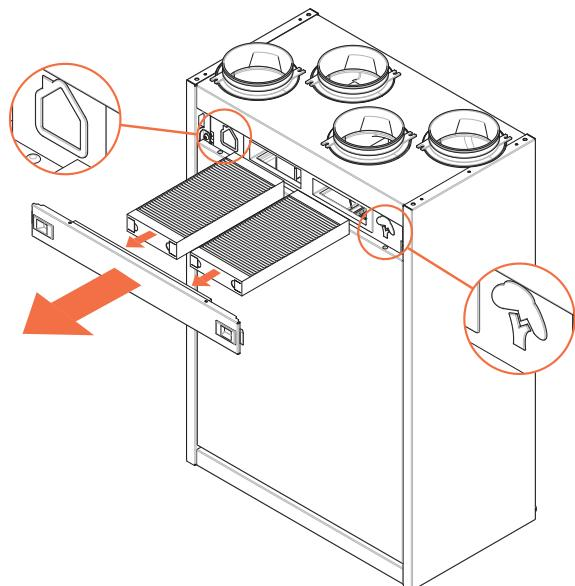
Remplacez les filtres (air soufflé et air repris) par des jeux de filtres officiels pour les appareils de ventilation Vasco de type D. Ils sont disponibles chez les grossistes ou dans le « Accessory Shop » de Vasco. Réinitialisez ensuite le message relatif au filtre à impuretés en appuyant simultanément sur les boutons « Position 1 » et « Minuterie» pendant au moins 4 secondes, jusqu'à ce que la LED s'allume en vert.
