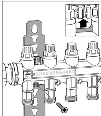
Plaats de collector in de dragers, zoals op de afbeelding, en gebruik de schroeven die in de verpakking zitten om alles vast te zetten.
