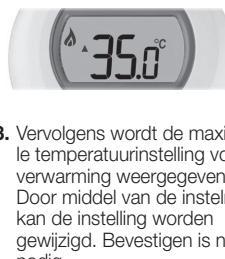
3. Vervolgens wordt de maximale temperatuurstelling voor verwarming weergegeven. Door middel van de instelring kan de instelling worden gewijzigd. Bevestigen is niet nodig.
