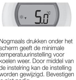
6. Nogmaals drukken onder het scherm geeft de minimale temperatuurstelling voor koelen weer. Door middel van de instelring kan de instelling worden gewijzigd. Bevestigen is niet nodig.
