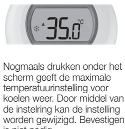
5. Nogmaals drukken onder het scherm geeft de maximale temperatuurstelling voor koelen weer. Door middel van de instelring kan de instelling worden gewijzigd. Bevestigen is niet nodig.
