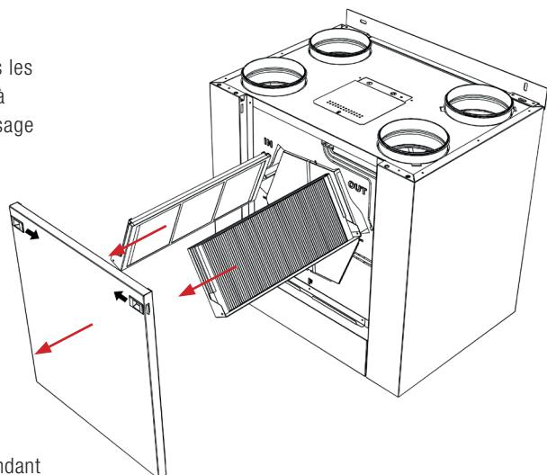
Remplacez les filtres (air d'alimentation et air de retour) par des jeux de filtres officiels pour les unités de ventilation Vasco de type D. Disponible chez les grossistes ou dans la "Boutique d'Accessoires" de Vasco. Ensuite, réinitialisez le message du filtre à impuretés en appuyant simultanément pendant au moins 4 secondes sur les touches "position 1" et "timer" jusqu'à ce que la LED s'allume en vert.
