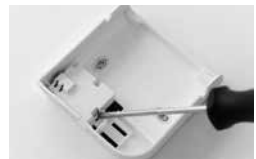
Stap 3: Open de klep op de basisplaat om de elek- trische aansluitingen zichtbaar te maken.
