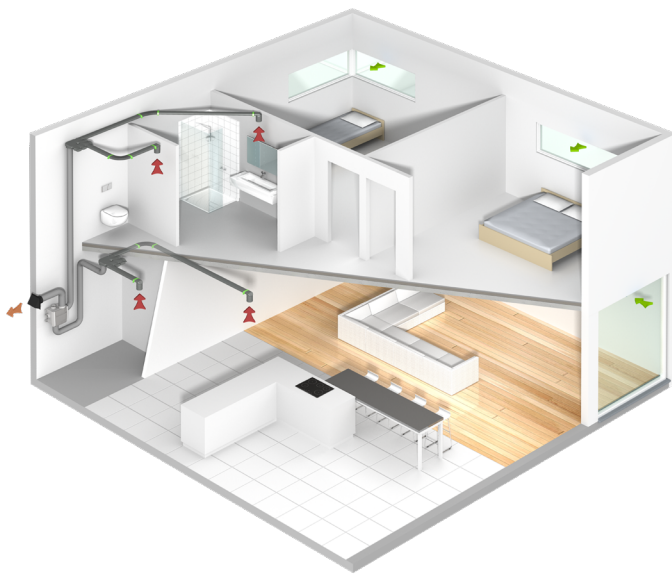
Mechanische ventilatie (systeem C)
