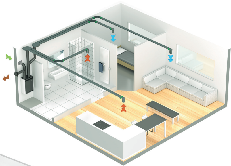
Balansventilatie (systeem D)
