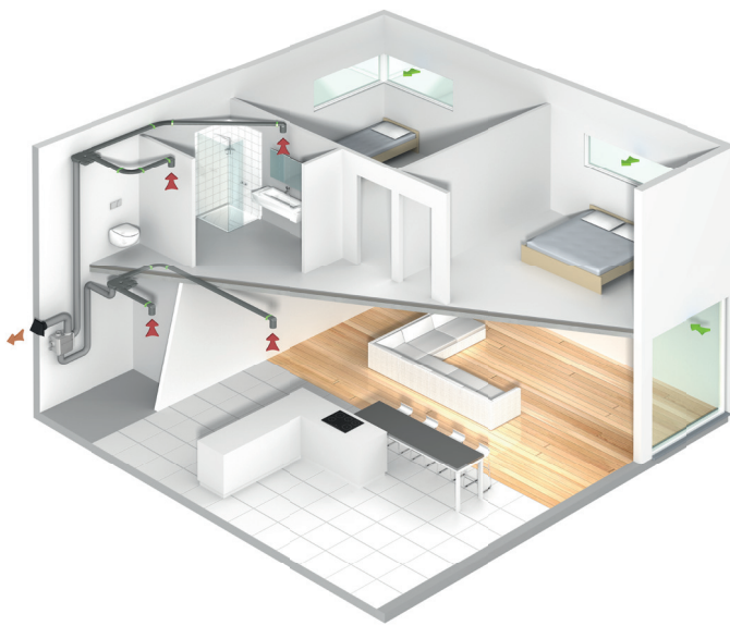
Mechanische ventilatie (systeem C)
