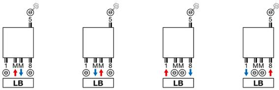
**Achtung:** der Anschluss des Heizkörpers kann nur durch die Anschluss-Symbole wie angezeigt erfolgen. Für jede andere Anschlussmethode, übernehmen wir keine Haftung.
