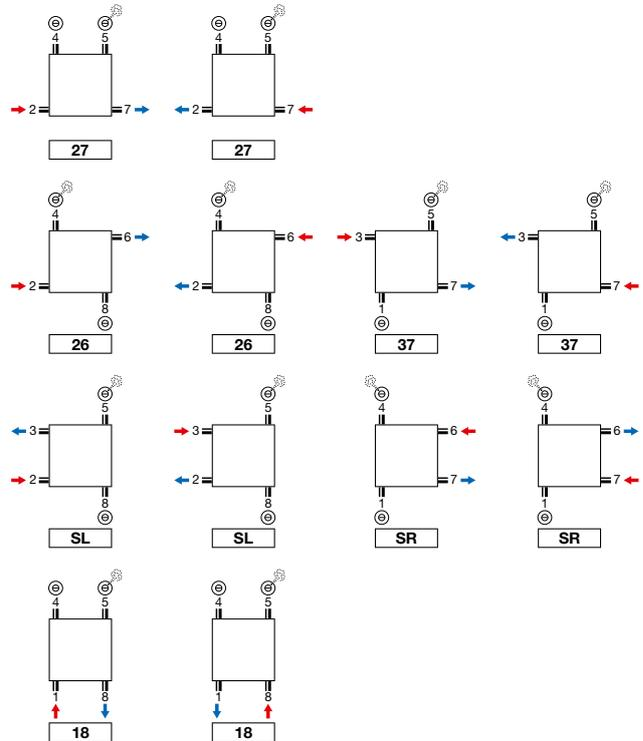
**Achtung:** der Anschluss des Heizkörpers kann nur durch die Anschluss-Symbole wie angezeigt erfolgen. Für jede andere Anschlussmethode, übernehmen wir keine Haftung.
