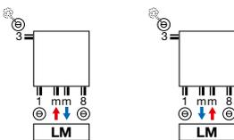
mm Anschluss nur bei gerader Rohranzahl möglich
