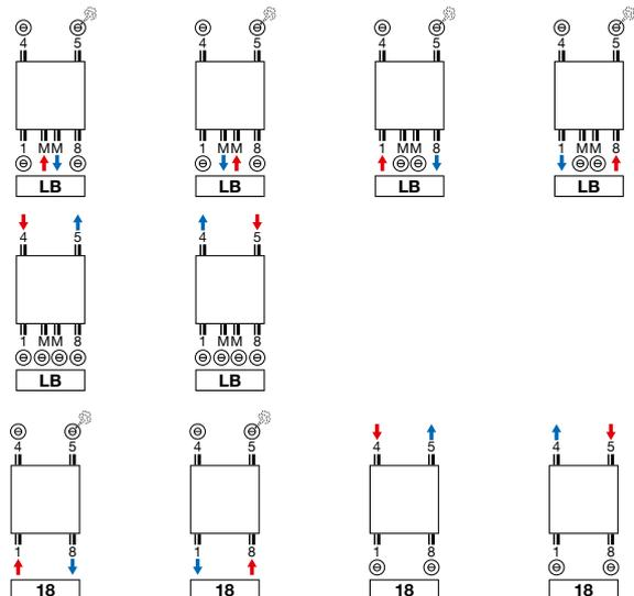
**Achtung:** der Anschluss des Heizkörpers kann nur durch die Anschluss-Symbole wie angezeigt erfolgen. Für jede andere Anschlussmethode, übernehmen wir keine Haftung.
