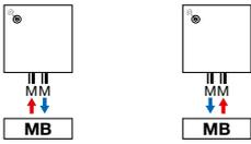
**Achtung:** der Anschluss des Heizkörpers kann nur durch die Anschluss-Symbole wie angezeigt erfolgen. Für jede andere Anschlussmethode, übernehmen wir keine Haftung.
