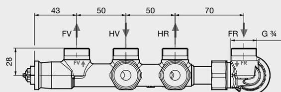
FV = Fußbodenheizung Vorlauf
