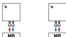
**Achtung:** der Anschluss des Heizkörpers kann nur durch die Anschluss-Symbole wie angezeigt erfolgen. Für jede andere Anschlussmethode, übernehmen wir keine Haftung.
