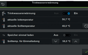
bedrijfsstatussen: warmwaterbereiding instellen
