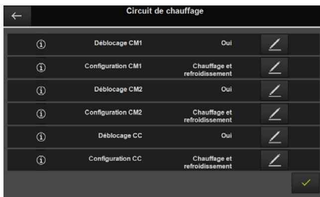
Fig. 6: Assistant de mise en service «Circuits de chauffage»
