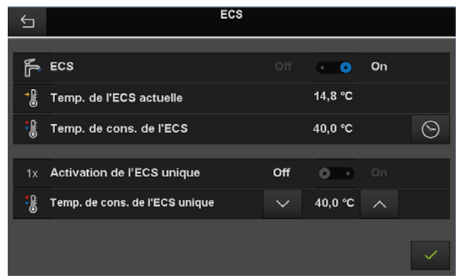
Fig. 27: Menu «Réchauffement de l'eau sanitaire»
