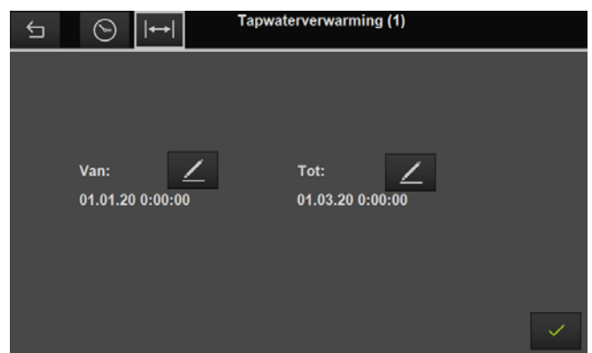
Fig. 22: Bewerken van tijdprogramma's -> Activeren gedurende een langere tijdsperiode
