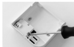
Étape 3: Ouvrez le clapet sur la plaque de base pour que les connecteurs électriques soient visibles.
